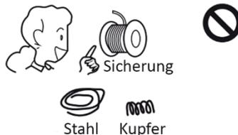
Unterbrecher Bitte wählen Sie die richtige Sicherung oder den richtigen Unterbrecher gemäß den Empfehlungen. Stahldraht oder Kupferdraht kann nicht als Ersatz für eine Sicherung oder einen Unterbrecher verwendet werden. Andernfalls kann es zu Schäden kommen.
